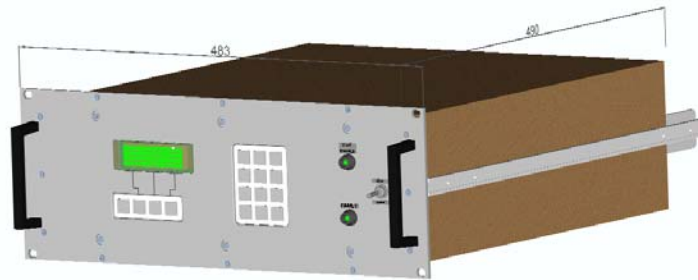
Tiroir de commande (au PC Telec)
